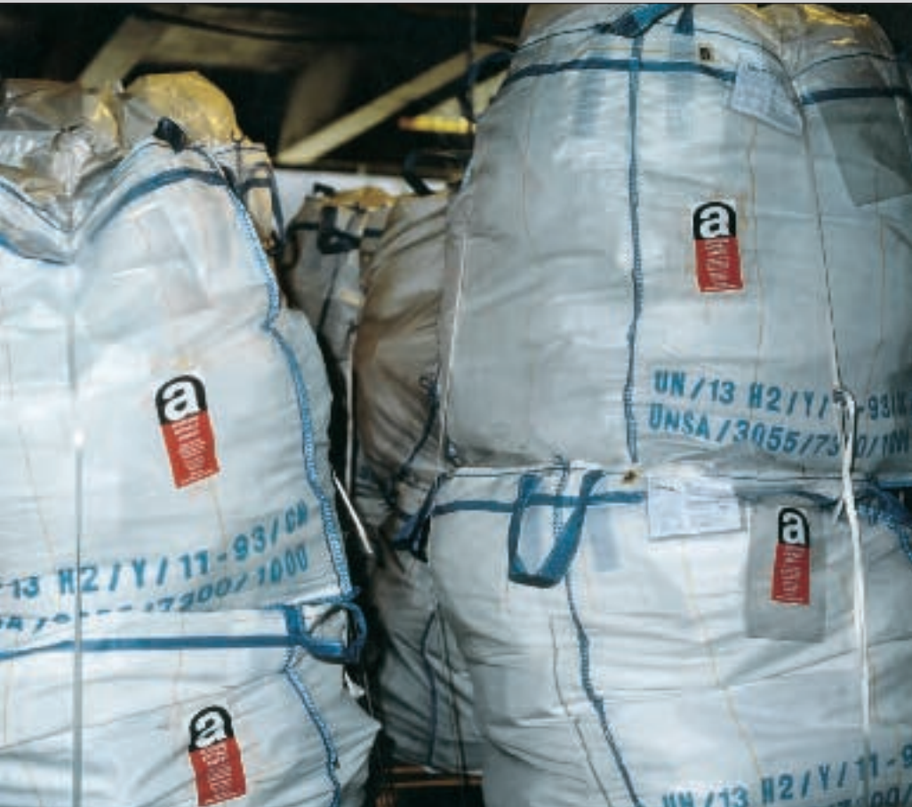
In Big-Bags verpackter Asbestabfall
