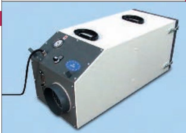
Luftaustausch-/Unterdruckhaltergerät mit 3-stufigem Filtersystem und einer Luftleistung von 900 m 3 /h, Gewicht 24,0 kg, geeignet für kleinere Räume (Quelle Deconta)
