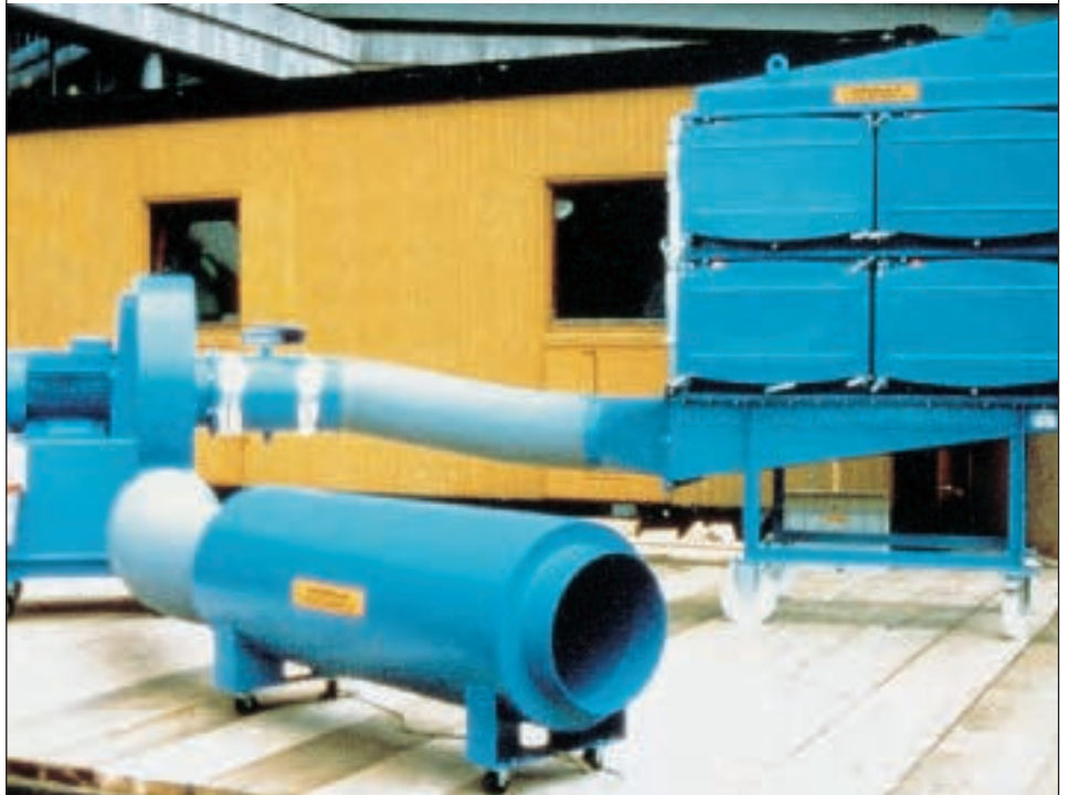
Luftaustauschgerät zur Unterdruckhaltung
